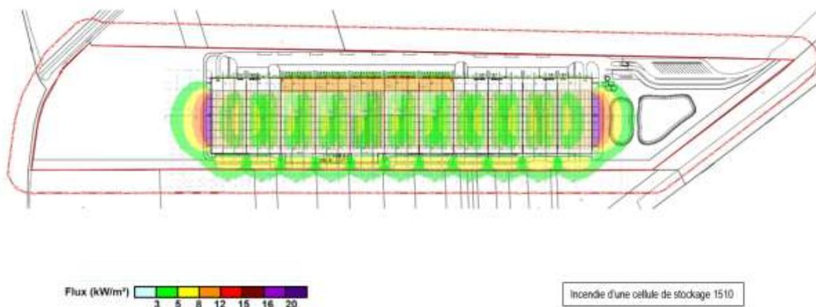
Le schéma de visualisation des flux thermiques ci-avant permet de constater que, quelle que soit la cellule étudiée et quelle que soit la typologie de produits stockés, en cas d'incendie d'une cellule de stockage :
